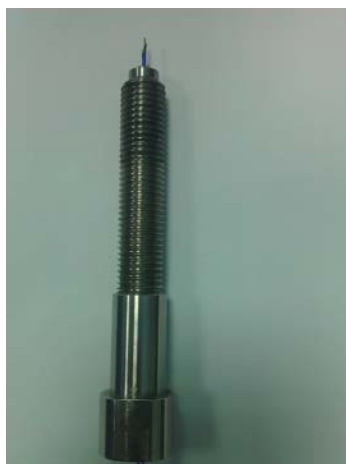
Рис. 2. Зонд для измерения температуры. Датчик температуры на базе «бусинкового» термистора
