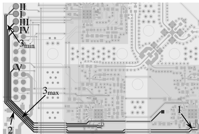
Рис. 3. Локализация пиковых значений напряжения на фрагменте печатной платы РПУ САН V. РЕЗУЛЬТАТЫ МОДЕЛИРОВАНИЯ
